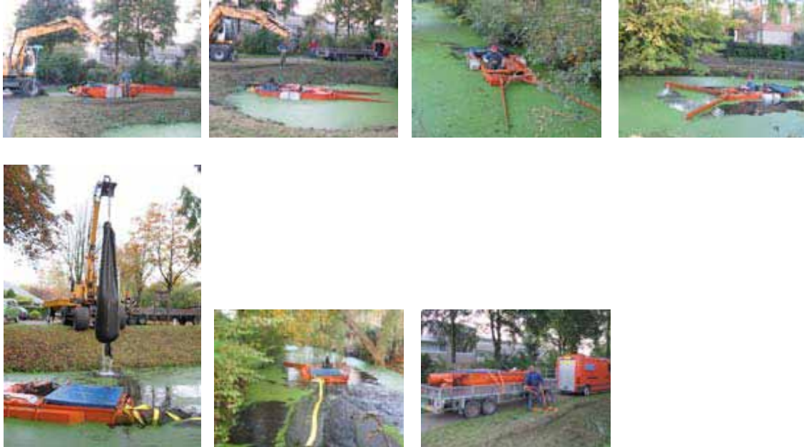
FIGUUR 6.4 DETAILFOTO'S VAN DE KROOSKARPER
